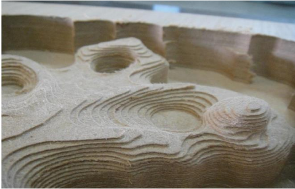
Εικ. 7: Αποτέλεσμα της φάσης ξεχονδρίσματος με βηματική βύθιση 1mm (Cut Increment)
