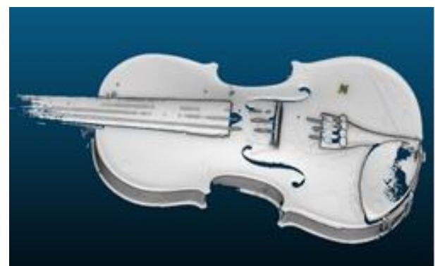
Εικόνα 3 Τρισδιάστατη απεικόνιση βιολιού πριν και μετά την αύξηση ευαισθησίας της κάμερας. Φαίνεται η καταγραφή πιο πολλών σημείων που ήταν με μαύρο χρώμα.
