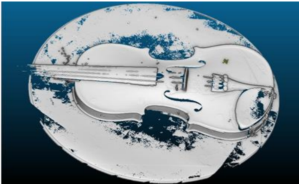
Εικόνα 1 Το πλήθος όλων των τρισδιάστατων σημείων που μετρήθηκαν κατά την διάρκεια της σάρωσης του βιολιού
