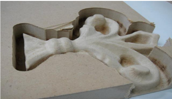
Εικ. 7: Αποτέλεσμα της φάσης ξεχονδρίσματος με βηματική βύθιση 1mm (Cut Increment)
