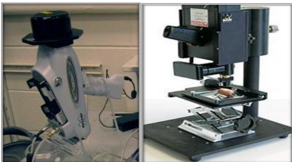
Εικόνα 2: το φορητό XRF Bruker Tracer III-SD και το 785 nm DeltaNu φασματόμετρο Raman
