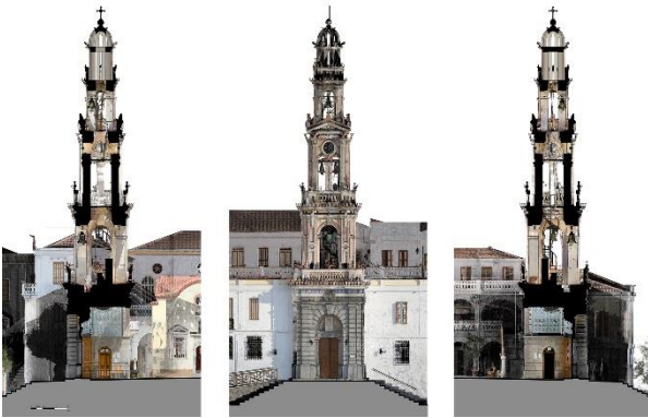
Εικόνα 3: Σχέδιο κύριας όψης και εγκάρσιων τομών του Κωδωνοστασίου – αποτέλεσμα επεξεργασίας των ορθών προβολών του τρισδιάστατου μοντέλου σημείων.
