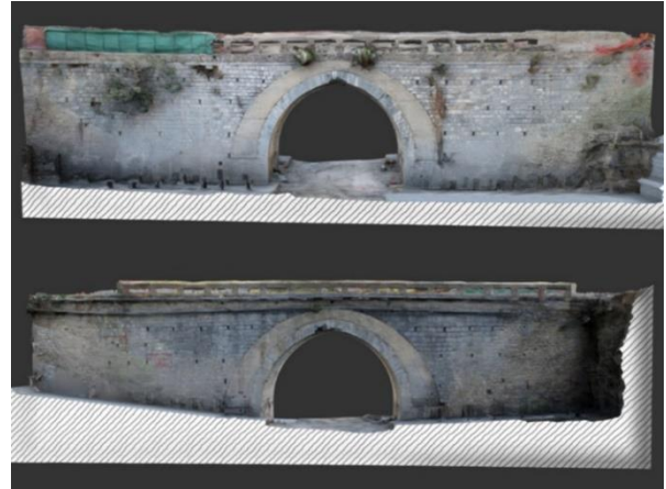
Εικόνα 1: Οι δύο πλευρές του γεφυριού όπως αποτυπώθηκαν στο τελικό επεξεργασμένο 3D μοντέλο με τη διαδικασία της φωτογραμμετρίας
