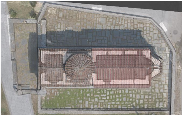
Εικόνα 5: συνένωση επίγειας σάρωσης με εναέρια φωτογραμμετρία.
