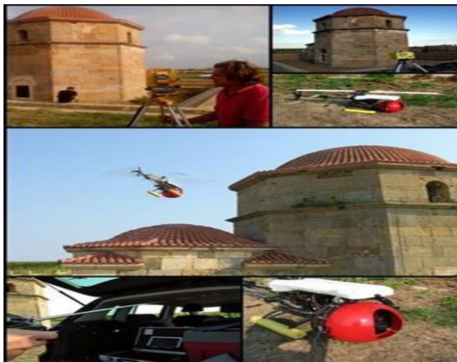
Εικόνα 2. Παράδειγμα ψηφιοποίησης πολιτιστικού μνημείου με τη χρήση μη επανδρωμένου πτητικού μέσου
