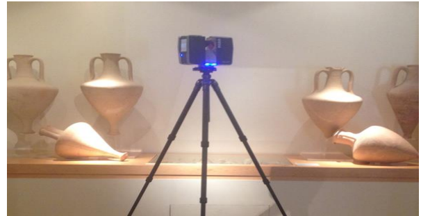
Εικ.1: Ο σαρωτής Laser Scanner Focus3D X 130 της FARO.
