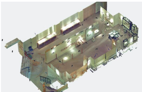
Εικ.7: Το διορθωμένο νέφος σημείων τμήματος του μουσείου στο λογισμικό FARO Scene.
