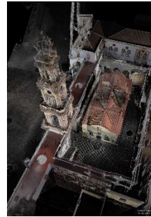
Εικόνα 1: Τρισδιάστατες απεικονίσεις από το μοντέλο σημείων (αποτέλεσμα της τρισδιάστατης σάρωσης) του πύργου του Κωδωνοστασίου και η σχέση του με το μοναστηριακό συγκρότημα.
